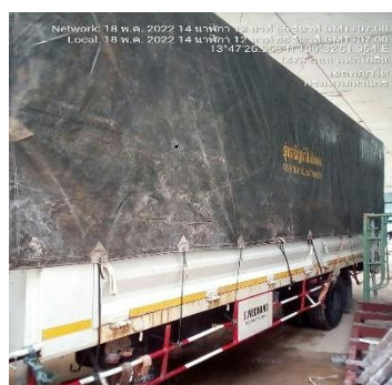
ภาพที่ 2.2-6 การปิดคลุมหลังกระบะของรถบรรทุก
